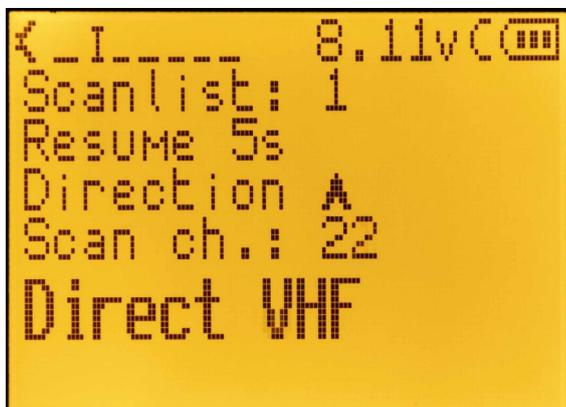
Parametri per la scansione. Menu accessibile anche con i tasti **F** + **\* Scan**.
