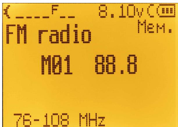
Con i tasti **su** **^** e **giù** **v** in Memory percorre le memorie già registrate (Mi Memory input), mentre in modo Frequency permette di inserire e cercare frequenze
